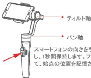
スマートフォンの向きを手動で始点の位置に変更し、1秒間保持します。ファンクションボタンを押して、始点の位置を記憶させます。
